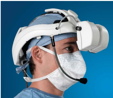
Abbildung 1: Beispiel eines Head Mounted Displays von Viking Systems. [62]
